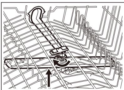
3. 用自來水沖洗噴水臂。使用細尖頭工具，例如牙籤，清除孔洞裡的污垢。
