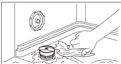
6. 以順時鐘方向旋轉軟化鹽槽的蓋子以關上軟化鹽槽。
