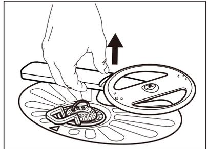
2. 用自來水沖洗噴水臂。使用細尖頭工具，如牙籤，清除孔洞裡的污垢。
