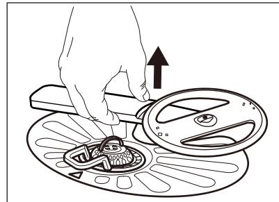
2. 用自來水沖洗噴水臂。使用細尖頭工具，如牙籤，清除孔洞裡的污垢。
