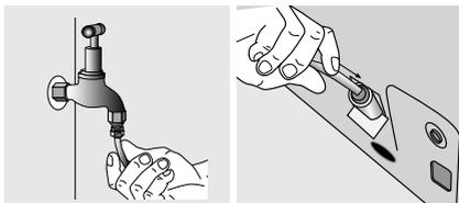
步驟 5 打開水並檢查所有接頭與管線是否有漏水。
