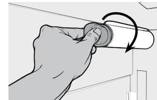
6. 檢查淨水濾芯外殼是否滲漏，並將一杯水壓在飲水機口。排出飲水機系統的空氣時所噴濺的水屬於正常現象。
