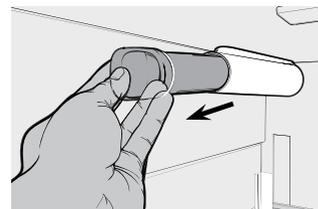
4. 拆開新淨水濾芯包裝並沿著對準導軌輕輕將其放入濾芯外殼，直到碰到外殼背面的濾芯連接處停止。
