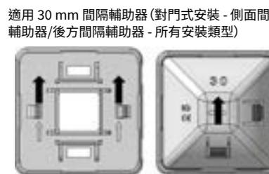
旋轉上半部，讓上半部的 30 標記朝上。將上、下兩個料件牢固緊扣一起即可形成一組 30mm 厚度的間隔輔助器。
